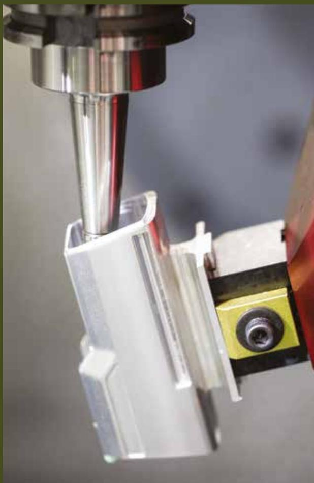
***Lavorazione di un componente nel Laboratorio di Prototipazione. Qui vengono realizzati pezzi unici con un processo che richiede frequenti cambi utensile e lavorazioni molto differenti tra loro.***
