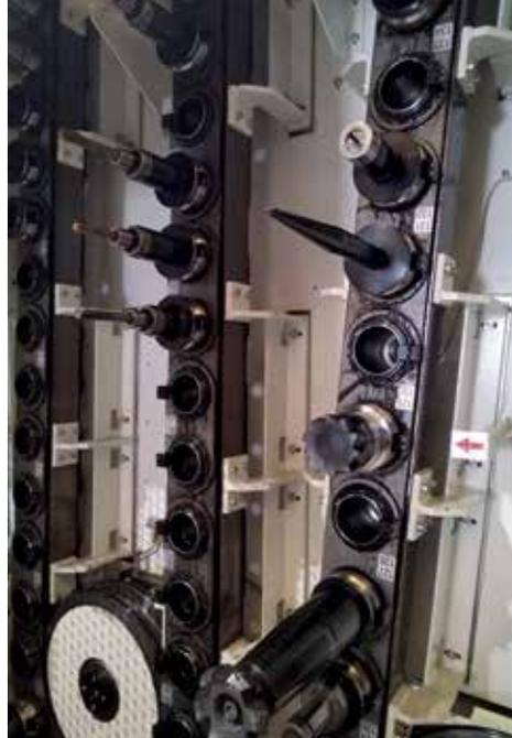
*Sopra: i magazzini utensili delle macchine del parco di OML sono attrezzati con diverse soluzioni di Big Kaiser*
